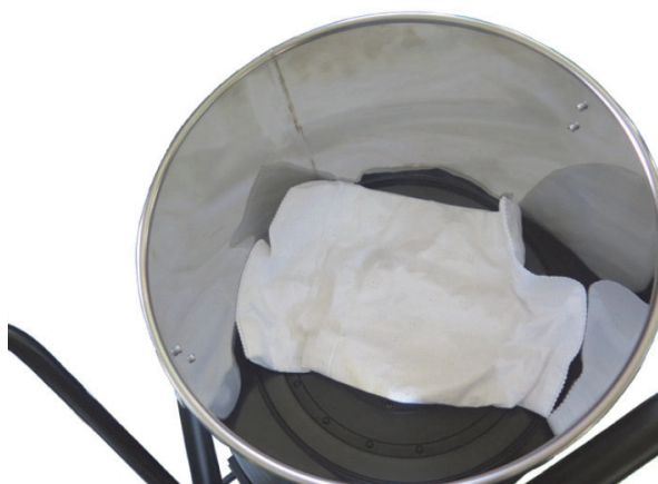
Obr. 4: Správná poloha filtračního vaku
